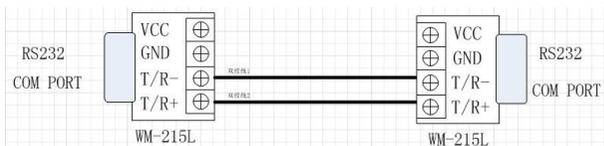
需要把 RS232 信号远传时,可以采用 WM-215L 对联,既采用 RS485 直连实现,这时需要注意两端的 RS232 端口不是标准,因为要从 RS232 端口取电,如果有一端电压不足,就会导致通信故障,解决办法是一端用有源 WM-306,另一端用无源的 WM-215L。
